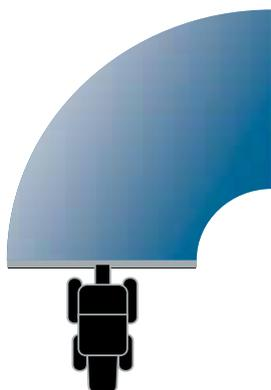
Le bout extérieur de la rampe peut aller à une vitesse jusqu'à 3 fois plus rapide que la machine elle-même.
