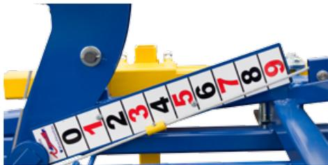
Le réglage obtenu peut être lu directement sur une réglette graduée généreusement dimensionnée placée sur le haut de l'appareil. Chaque type de herse étrille peut être équipée d'un vérin hydraulique destiné au réglage de la pression des dents.
