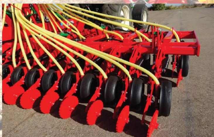
ROUES DE RAPPUI RAINUREES FONTE ET « SABOT ENFOUSSEUR » POUR UN PARFAIT CONTACT SOL/ GRAINE FACILITANT L'ECLOSION RAPIDE ET SÛRE
