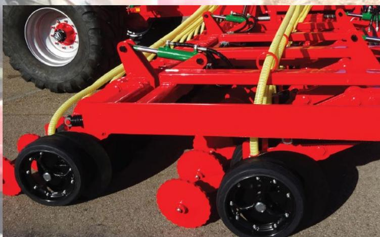
SYSTEME HYDRAULIQUE PERMETTANT DE REGULER LA PRESSION AU SOL DES ELEMENTS SEMEURS ET DE LES RELEVER LORS DES MANOEUVRES
