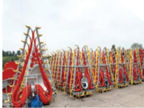
**Ils ont également mis au point des kits rétrofit en rééquipement avec châssis rampe à pendillards, patins et flexishoe qui peuvent être installés sur n'importe quelle marque de tonne à lisier sans avoir à souder des supports spécifiques.**
