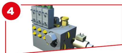
**4** Toutes les fonctions hydrauliques sont commandées par un **seul circuit hydraulique intégré**. De cette façon, un minimum de raccords et flexibles est nécessaire. Le système ne nécessite qu'un seul distributeur hydraulique simple effet. Le circuit peut s'adapter soit à du load sensing ou à une pompe à débit continu.
