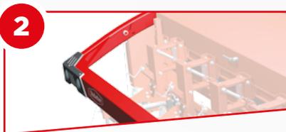
**2** À l'arrière de la machine se trouve un **cadre de sécurité** repliable. Sa fonction première est d'empêcher toute intrusion au niveau des lames mobiles lors du travail. Il sert également de pare-chocs lors des transports. Il est doté de feux LED de série. Une fois replié, un capteur bloque toute action des lames.
