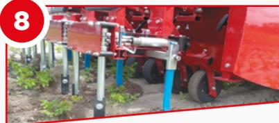
La hauteur entre les plants et les caméras est réglée via deux capteurs ultra-sons qui mesurent en continu cette hauteur. Montées sur vérins hydrauliques, les deux roues de jauges s'adaptent donc en continu indépendamment l'une de l'autre.
