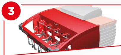
**3** À l'aide des images fournies par les caméras, situées dans le premier bâti fixe, le **second bâti est mobile latéralement** et ce jusqu'à 20 cm pour permettre aux éléments bineurs de rester exactement au-dessus des lignes de cultures.
