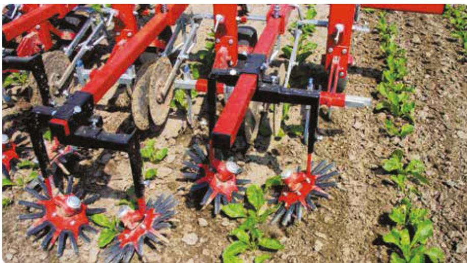
La sarclouse à doigts est composée d'une étoile avec des doigts en polyuréthane. Ces doigts fouillent entre les plantes cultivées et en frottant détruisent les adventices de plus petite taille. Dans des sols plus légers, l'étoile à doigts peut être remplacée par une étoile à brosses dans des cultures plus fragiles comme des légumes par exemple.
